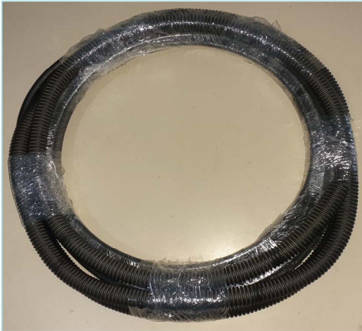
CABO FINALIZADO COM PROTEÇÃO DO CORDÃO ÓPTICO PARA LANÇAMENTO
